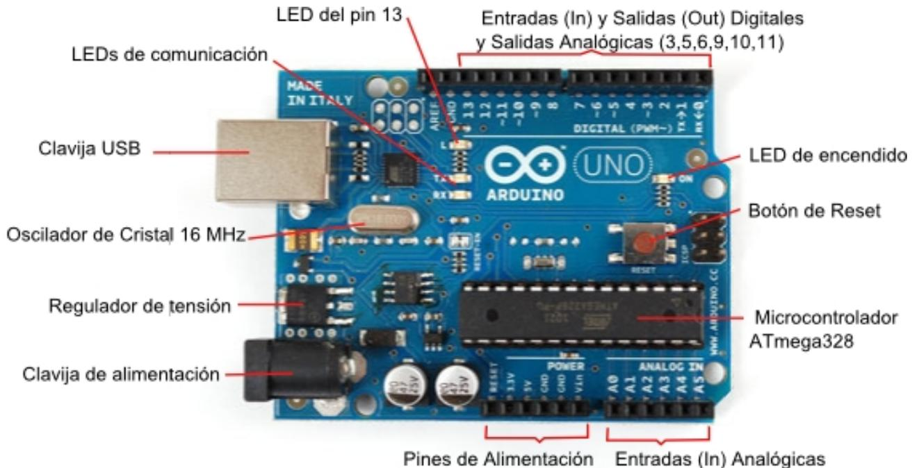
**Alimentación:** Arduino puede estar alimentado por dos vías:
