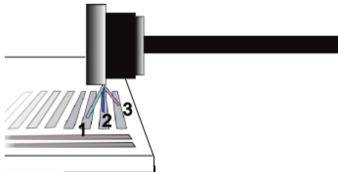
El truco para cablear dichas patillas es insertar el cable jumper para la patilla 2 previamente antes de intentar conectar el potenciómetro.
