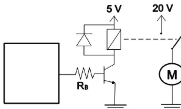
En esta ocasión, este montaje sólo permite **controlar el encendido y apagado** del motor, y siempre **girando en el mismo sentido** (no tiene sentido controlar la velocidad, pues el relé no tiene velocidad de cambio de posición de sus contactores como para “seguir” un PWM).
