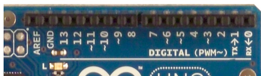
Ilustración 27: Detalle en el que se aprecian los pines con capacidad para generar señales PWM.
